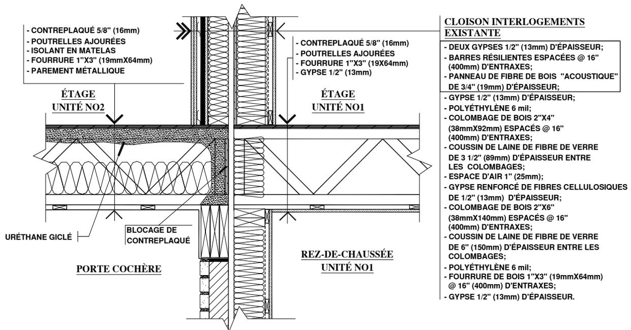
**FIGURE 2 - CLOISON no 2 (QUADRUPLE PAROI) - ASTC 49**
